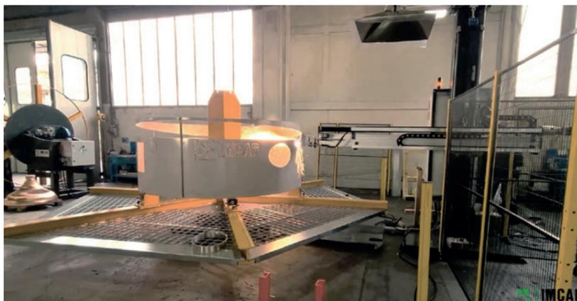
toi, in grado di eseguire tutte le operazioni di taglio per il collegamento di accessori, come porte e fondi inclinati.
